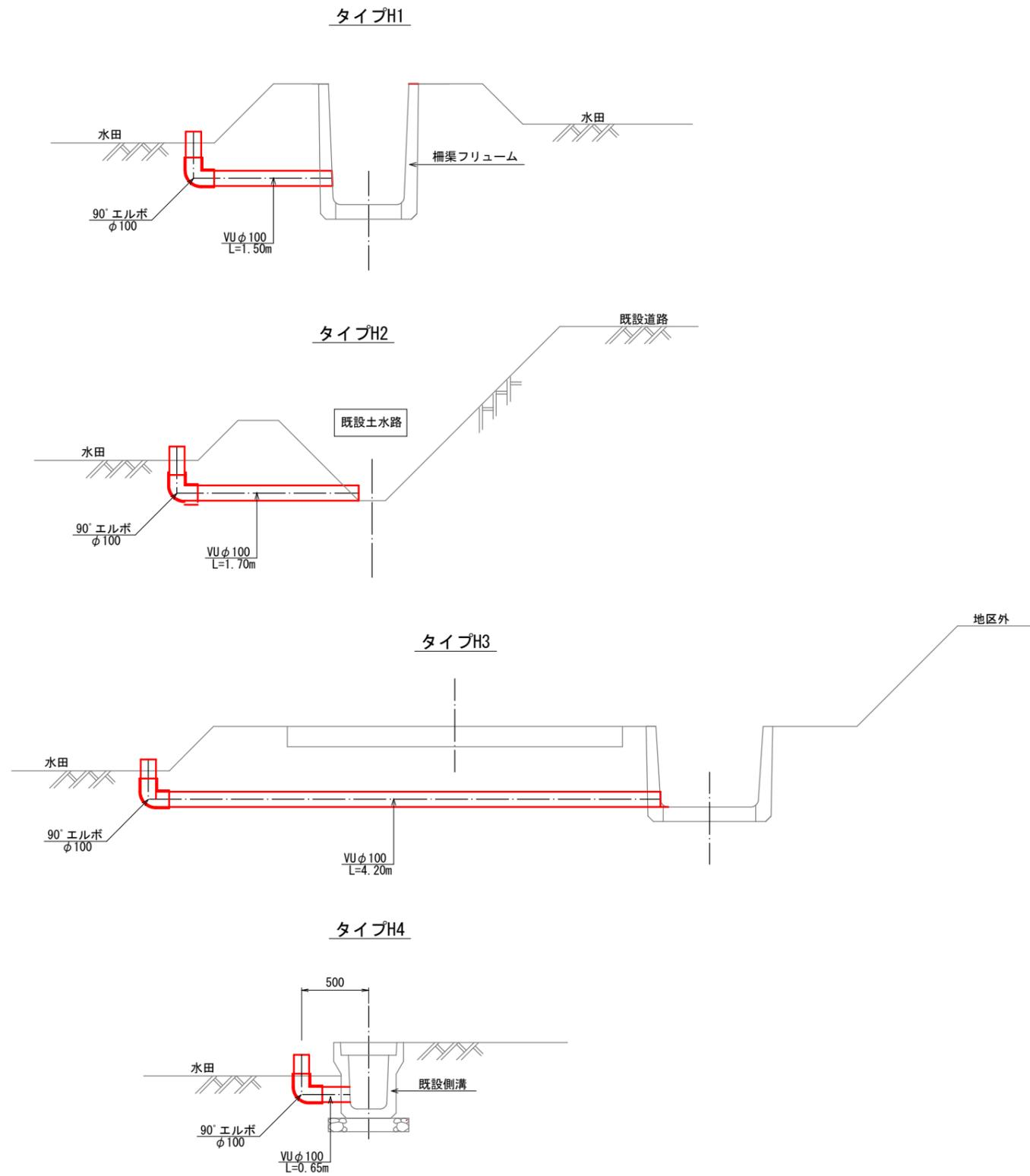
排水路末端処理工標準構造図
